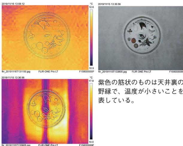
写真-5 果実図のサーモグラフィー計測（工事報告書より）
