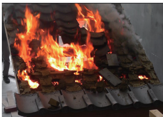
写真5 飛び火火災による炎上
