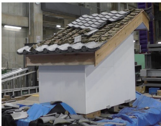
写真3 加振後の屋根の様子
