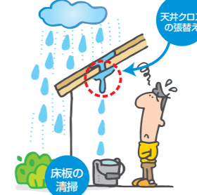
施工に不具合があり、雨水が家屋内に浸入、天井クロスを汚した。
